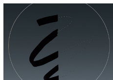
La Imagen ilustra resistencia a la suciedad (marcador a base de aceite) Lado izquierdo: Sin capa de Flúor Lado derecho: Con capa de Flúor
