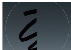
La imagen ilustra la resistencia a la mugre. (marcador de filtro a base de aceite) lado izquierdo: sin revestimiento de flúor lado derecho: con revestimiento de flúor
